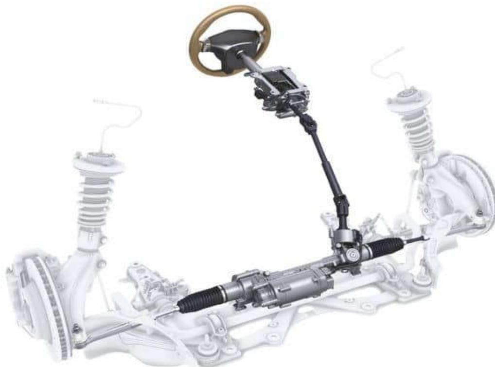
Как можно догадаться усилитель руля работает не все время. А лишь при повороте колес и не на высоких скоростях. Однако колеса поворачиваются при различных условиях. Соответственно и работа выполняемая двигателем разниться от условий. Современные блоки управления умеют определять в каком режиме двигается автомобиль и подстраивать крутящий момент двигателя под них.
