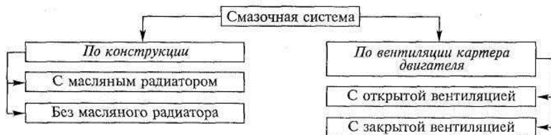
Рис. 11.1. Типы смазочных систем, классифицированные по различным признакам
