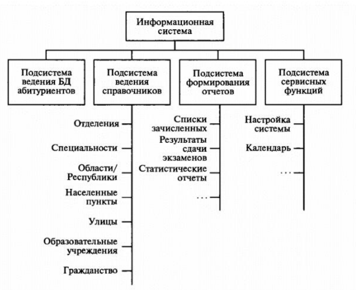
Рисунок 6. Структурная схема программной системы «Абитуриент».
